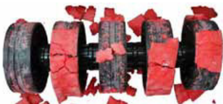
Rollen aus nicht hydrolysebeständigem Polyurethan
