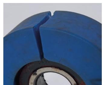
在80° C的水中浸泡 1,000 小时后，滚轮水解造成的损坏
