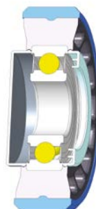
Rolle mit einseitiger Abdeckscheibe und Deckel (CCW)
