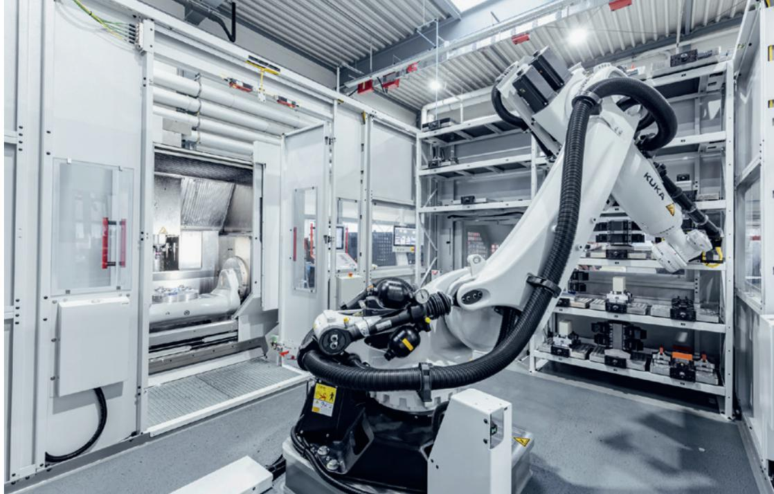
Hermle C400 5-Achs-Fräsmaschine mit RS2-Automation
