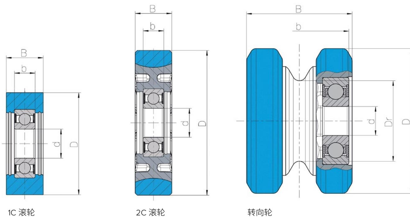
外径 (D) | 内径 (d) | 宽度 (B) | 轴承宽度 (b) | 带槽直径 (Dr)
