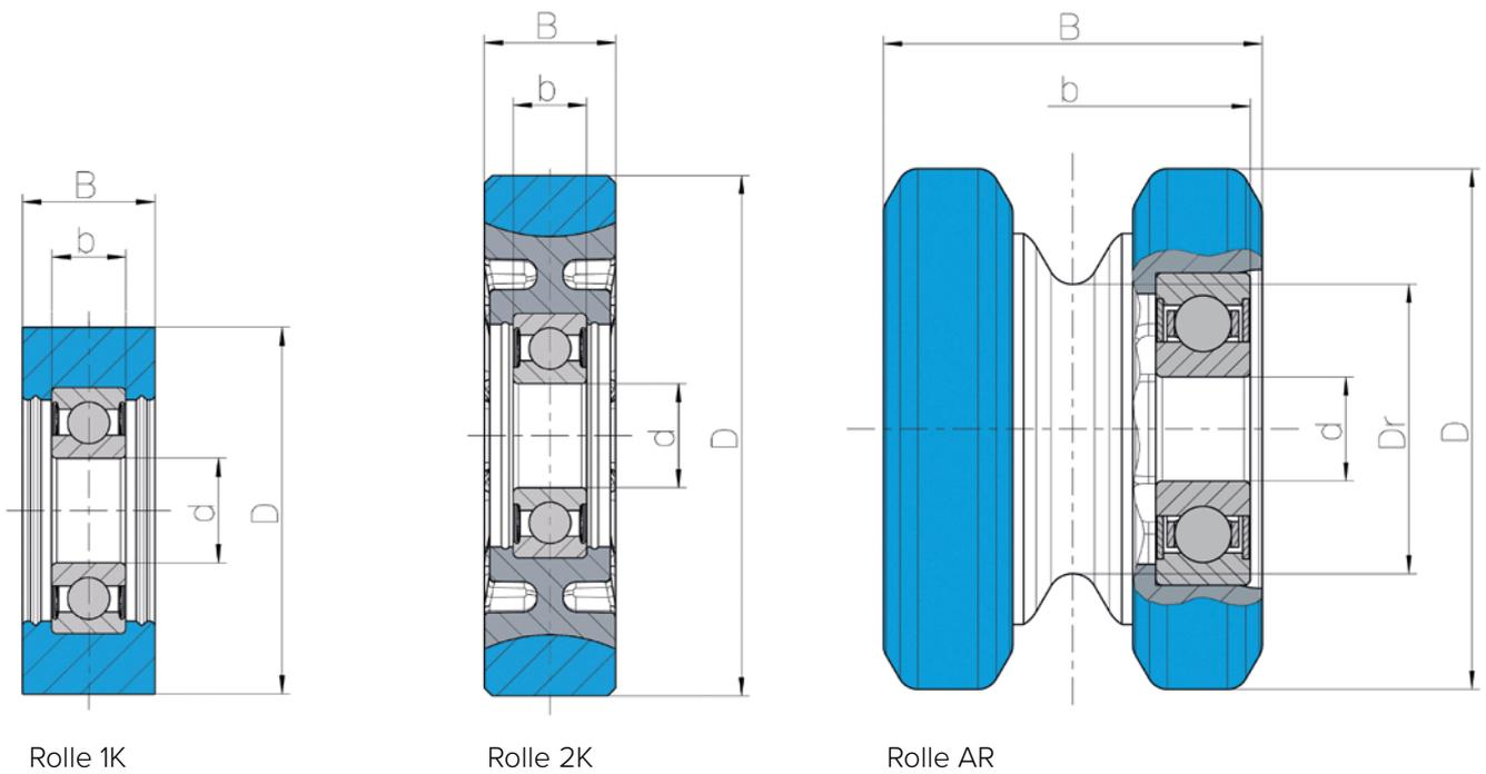
Außendurchmesser (D) | Innendurchmesser (d) | Breite (B) | Lagerbreite (b) | Durchmesser Riemennut (Dr)
